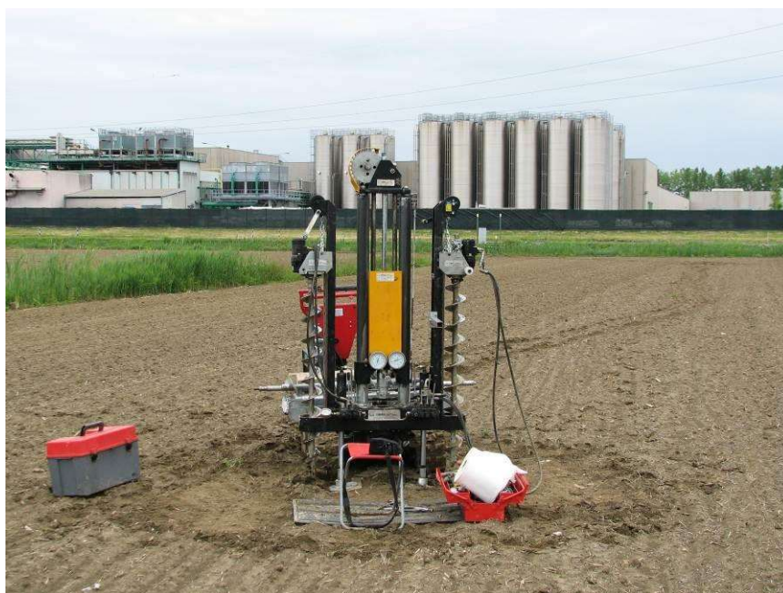
Penetrometro statico SP100SM su uno dei punti di indagine
